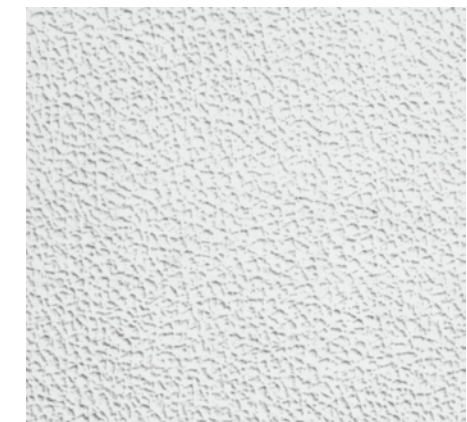
皮纹蚀纹 ( \times 1.5 ) 喷砂后的蚀纹表面
