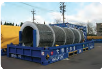
列車・トラックに共有可能な鋼材専用無蓋コンテナ
