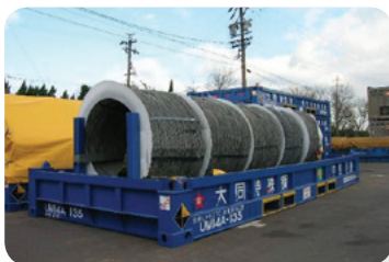
列車・トレーラーともに積載可能な鋼材専用無蓋コンテナ
