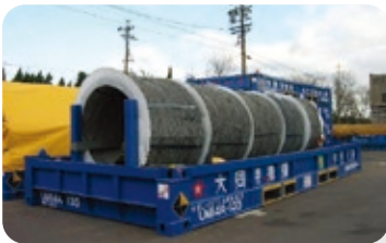
列車・トレーラー共に積載可能な鋼材専用無蓋コンテナ
