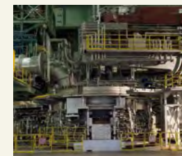
知多工場に導入した150t炉(STARQ®)
