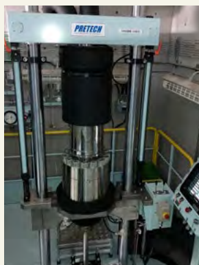
高圧水素ガス雰囲気材料試験機 (HyTReC 内設置)
