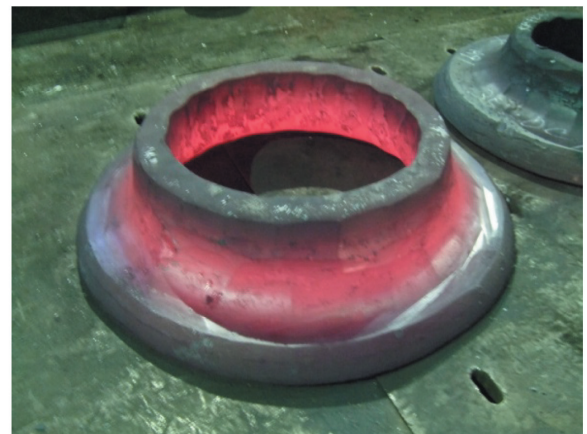
図3 インペラー素材(鍛造後)
