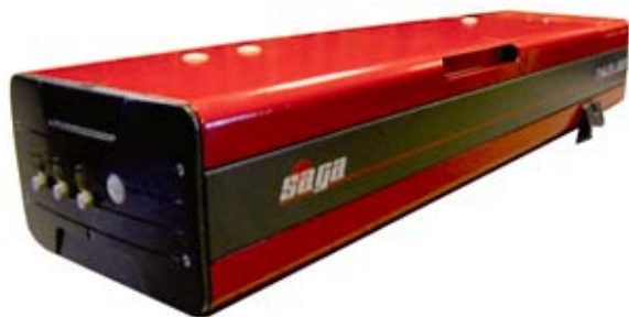
Fig. 8. Ultrasonic generation laser 13) .
