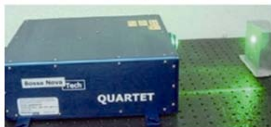
Fig. 9. Ultrasonic detection laser 13) .
