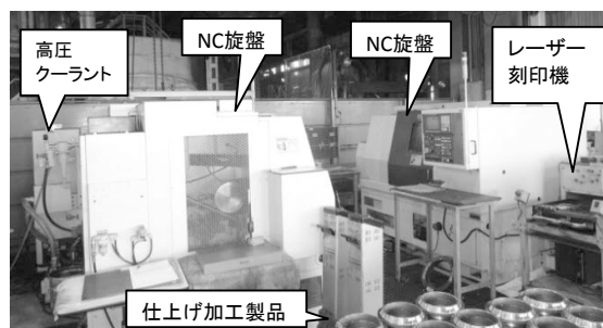
図 2. 製品加工 NC ライン。
