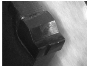
図4. \phi 580 鋸刃寿命5000個以上使用後状態。 チップは正常摩耗（逃げ摩耗0.1 mm） ただし歯数の約1/3はチッピング発生
